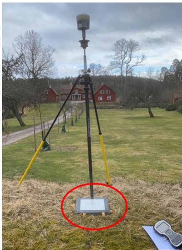
Figur 1 En flygssignal som mäts in med GNSS-utrustning
