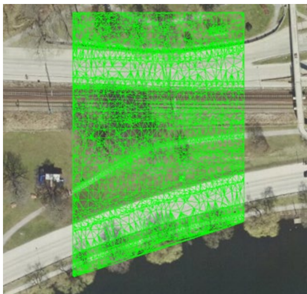
Figur 11 Markmodell skapad från punktmoln kombinerat med geodetiskt inmätta vägkanter
